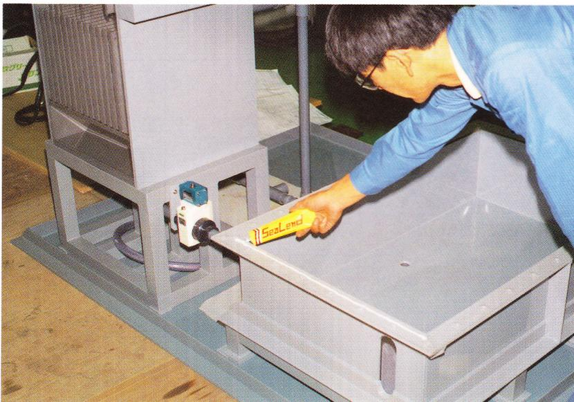
電子部品(C/P)洗浄装置塩酸槽カバー接合面 (No.5000FR)
